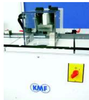
KMF-Innovation: Stanz- und Schneideaggregat für Kunststoffprofile.
