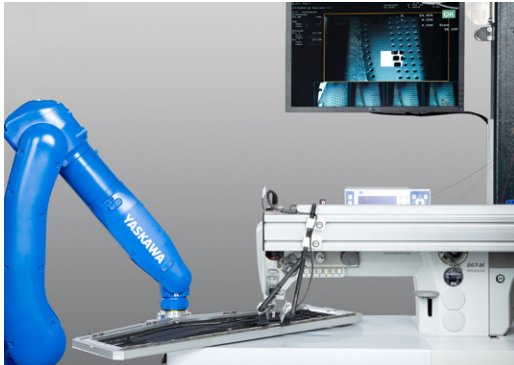
Ein Motoman GP7 von Yaskawa bildet die Basis für das vollautomatisierte Nähsystem RoQom 6000.
