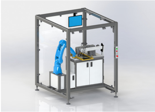
Stand-alone-Zelle mit Motoman GP 7 Sechssachser.
